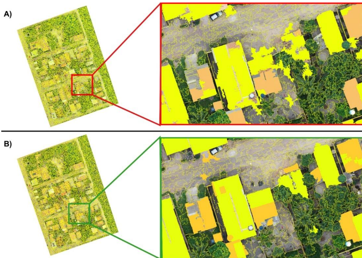
Figura 3 - Testes de segmentação combinados com áreas amostradas: A) RGBZ; B) PCA-RGBZ.
