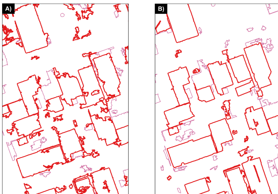
Figura 5 - Comparação do contorno dos telhados: A) RGBZ; B) PCA-RGBZ.
