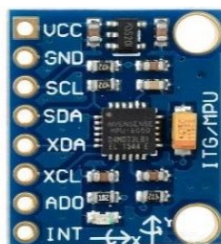
Figura 2 - A forma física do Módulo MPU6050.
