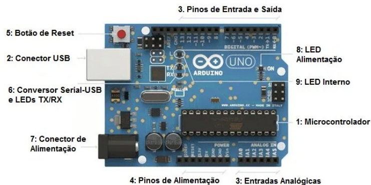
Figura 1 - Principais Pontos do Arduino.
